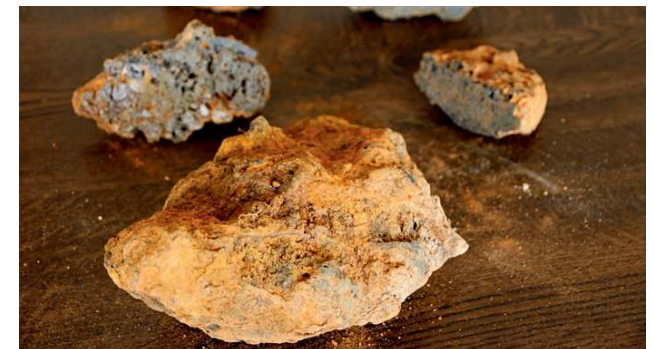
Ebenfalls historisch bedeutsam sind die sogenannten Luppen: Eisenbrocken, die in der historischen Roheisengewinnung durch Reduktion aus dem Erz entstanden.
